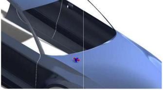
Support d'une hauteur de 40mm fixé par des vis avec une contre-plaque d'épaisseur mini de 3mm de surface de 120cm2. La contre plaque devra être située à l'intérieur de la carrosserie afin de prendre celle-ci en sandwich avec le
