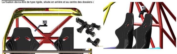
Pour les caméras de type « Crayon » elles pourront être fixées sur le montant de l'arceau avant et le boitier devra être fixé sur le plancher (idem fixation batterie) derrière les sièges.
