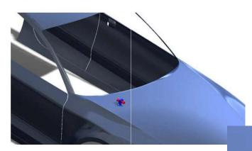
Support d'une hauteur de 40mm fixé par des vis avec une contre-plaque d'épaisseur mini de 3mm de surface de 120cm2.
