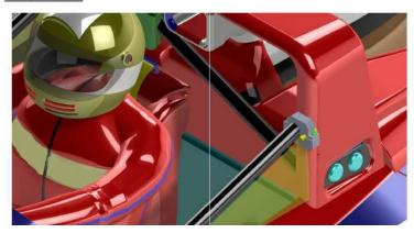
Support de la caméra crayon fixé mécaniquement sur le tube d'arceau
