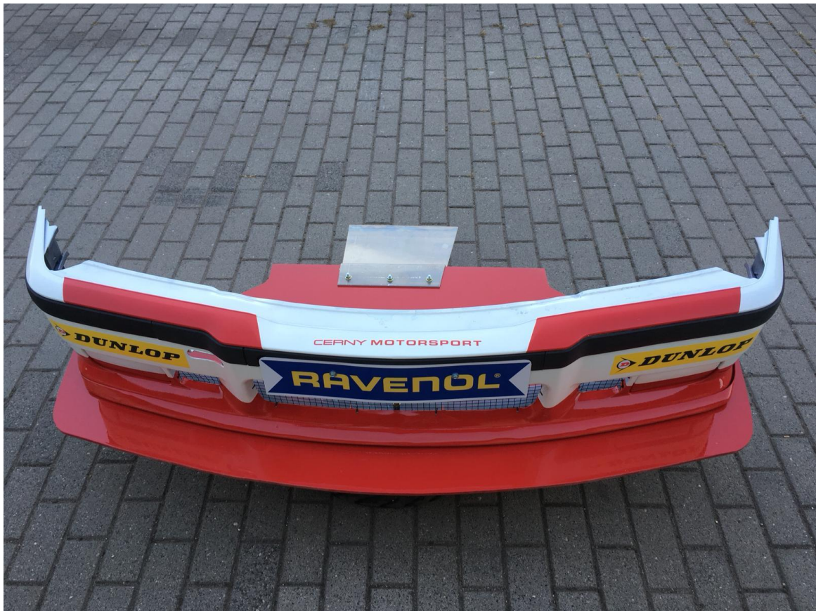
Abbildung 14 (Frontstoßstange mit Splitter)
