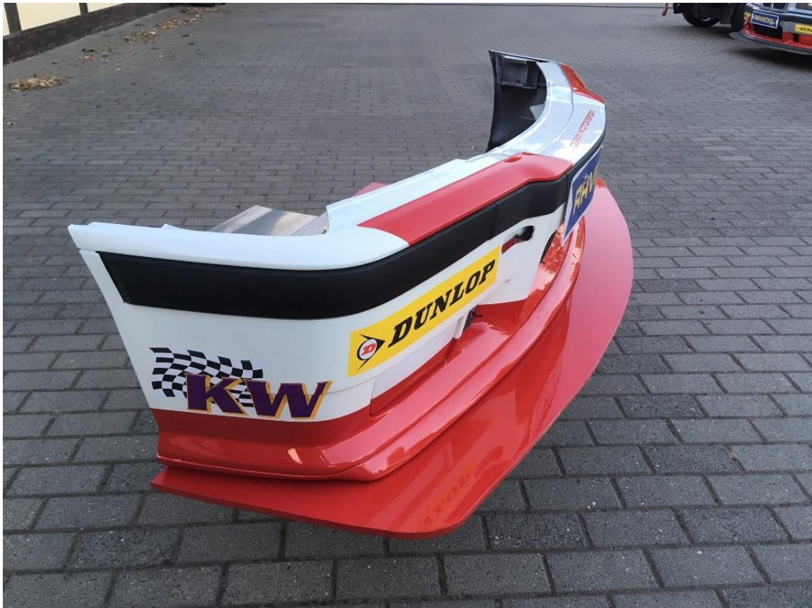
Abbildung 13 (Frontstoßstange mit Splitter)
